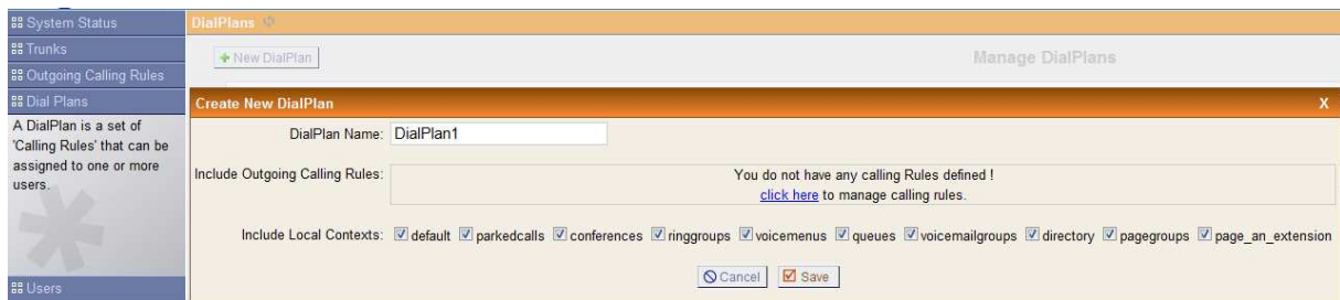
Obr. 12. Nastavení Dial plánů
